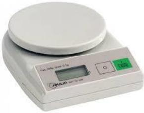
La **balance** est constituée d'un plateau, d'un écran et de deux boutons. Au collège, on dispose de balances de 200g, 2000g et 5000g. Leur précision varie : 0,1g et 1g.
