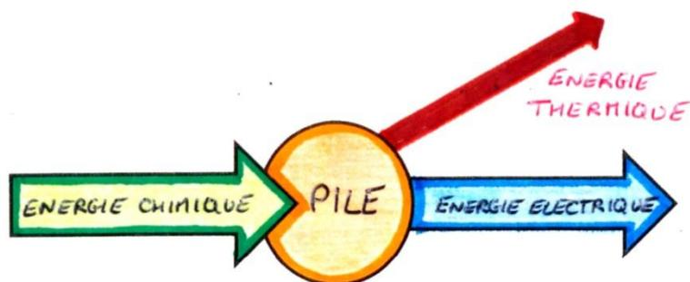
La pile stocke de l'énergie chimique qu'elle transforme en énergie électrique.
