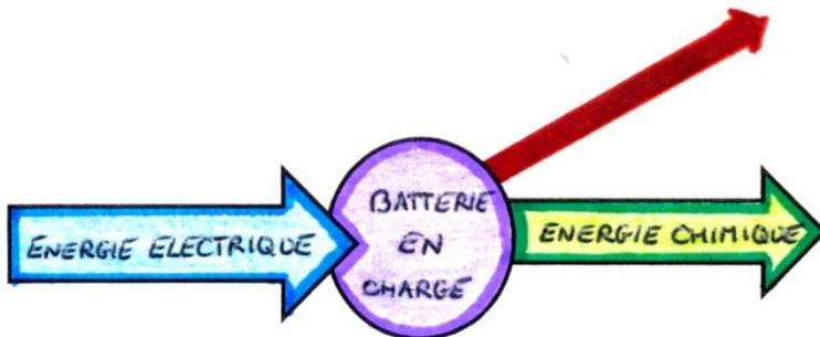
Une batterie en charge stocke l'énergie électrique sous forme d'énergie chimique.
