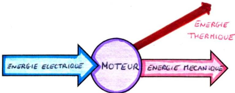
L'énergie électrique permet de faire tourner le moteur qui **s'échauffe**.
