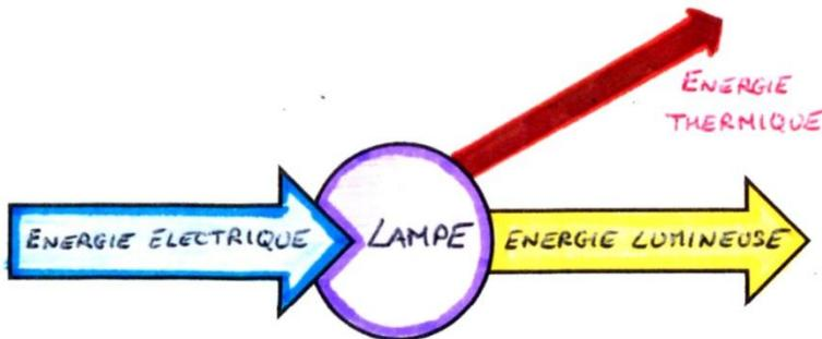
La lampe **chauffe** en produisant de la lumière à partir d'énergie électrique.
