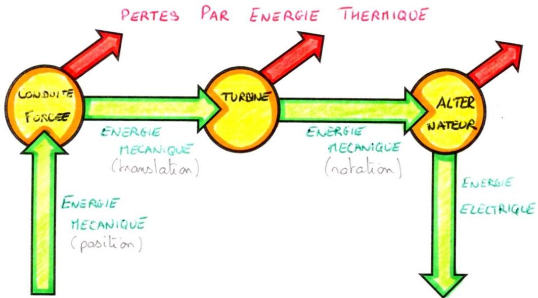
la chaîne énergétique pour un barrage hydraulique
