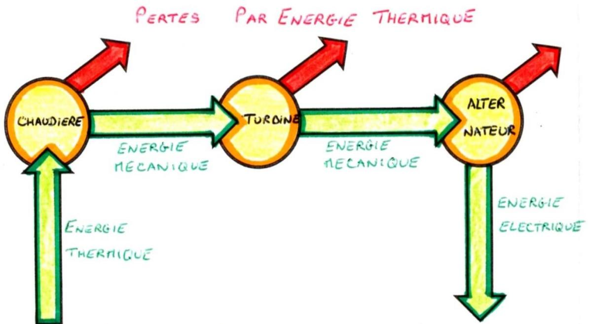
La chaîne énergétique pour une centrale thermique
